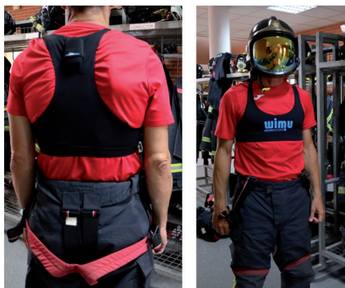
Figura 1. Adhesión del dispositivo WIMU en el arnés específico y colocación del mismo en uno de los sujetos participantes en la investigación.
