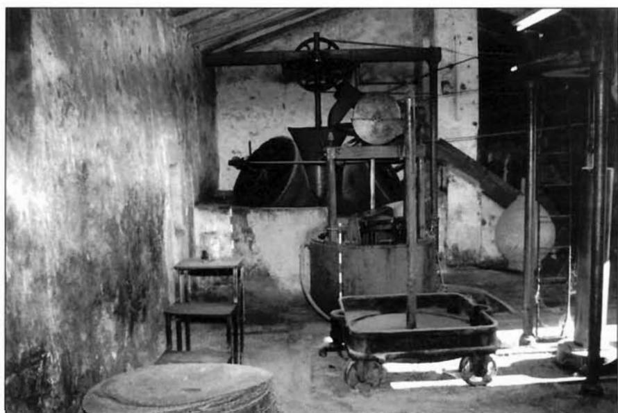
Foto 8: Vista general de la muela (8 y 9), batidora (10), prensa hidráulica (13), vagoneta y capachos (16).
