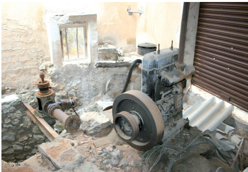
Figura 10. Estado actual del interior del pozo Las Cuevecicas, con los restos de la antigua instalación de extracción vertical de agua.
