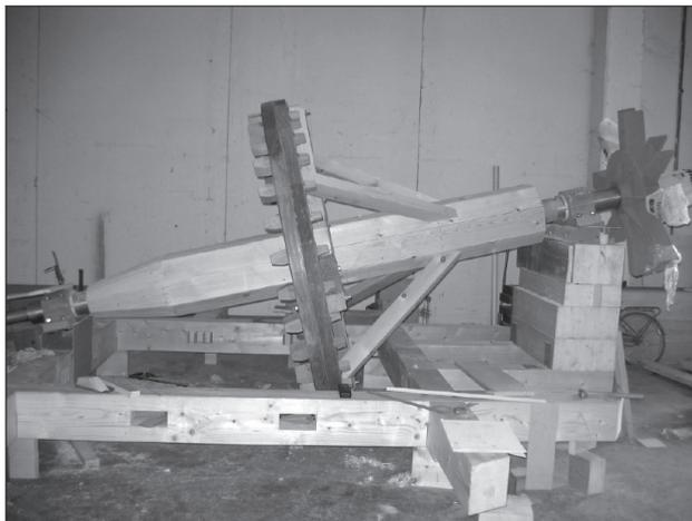
Dado que la vida de la madera utilizada en estos ejes se acorta de forma considerable por las grandes escopladuras para el pase de los cruceros y palos de aspas y su permanencia a la intemperie, es por lo que se ha construido de acero. Posteriormente se ha recubierto de madera para mantener la imagen de los construidos por este material.
