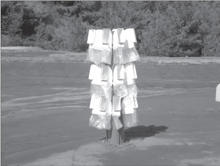
FIGURA 7: *Nuevo colector de erosión eólica.*
