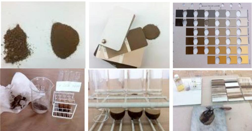
**Figura 21.** Identificación mediante medición del color y Notación Munsell; comprobación de insolubilidad; primeras pruebas de unificación textural y aplicabilidad en las técnicas de acrílico y óleo.
