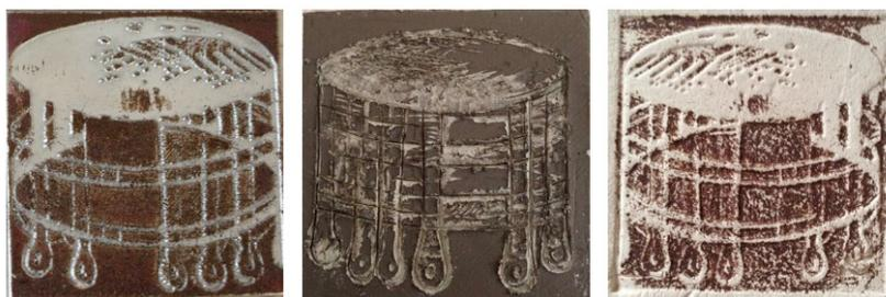
**Figura 17.** Resultados obtenidos: plancha entintada, esgrafiado, impresión sobre gres ( cocido a 1200°C).
