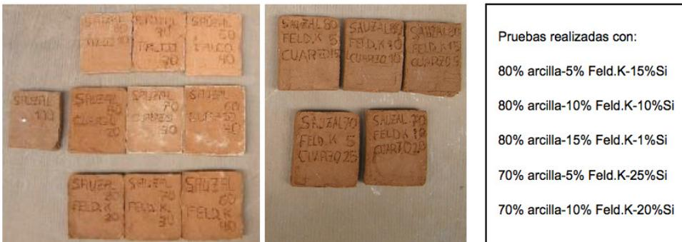
**Figura 12:** Pruebas con arcilla de El Sauzal y antiplásticos comerciales.
