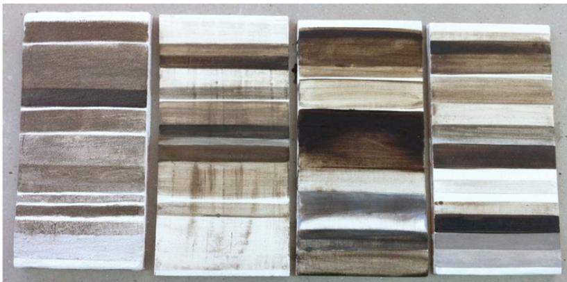
**Figura 22.** De izquierda a derecha: pruebas de aplicación al fresco (las dos primeras), al óleo y al acrílico.
