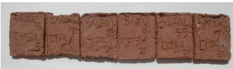
**Figura 13:** Pruebas con arcilla del Sauzal y sedimento en proporciones: 95-5, 90-10, 85-15, 80-20, 75-25, 70-30.
