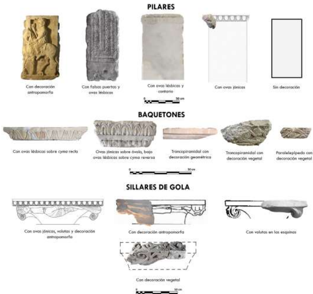
Figura 3. Síntesis del repertorio arquitectónico del “taller del Valle del Segura-Corredor de Montesa”. Fuente: Elaboración propia, salvo foto del pilar de falsas puertas (tomado de Almagro Gorbea et al., 2015, CC-BY-SA), la foto de la gola con volutas (cedido por Poveda) y los dibujos de las golas (tomado de Izquierdo, 2000).
