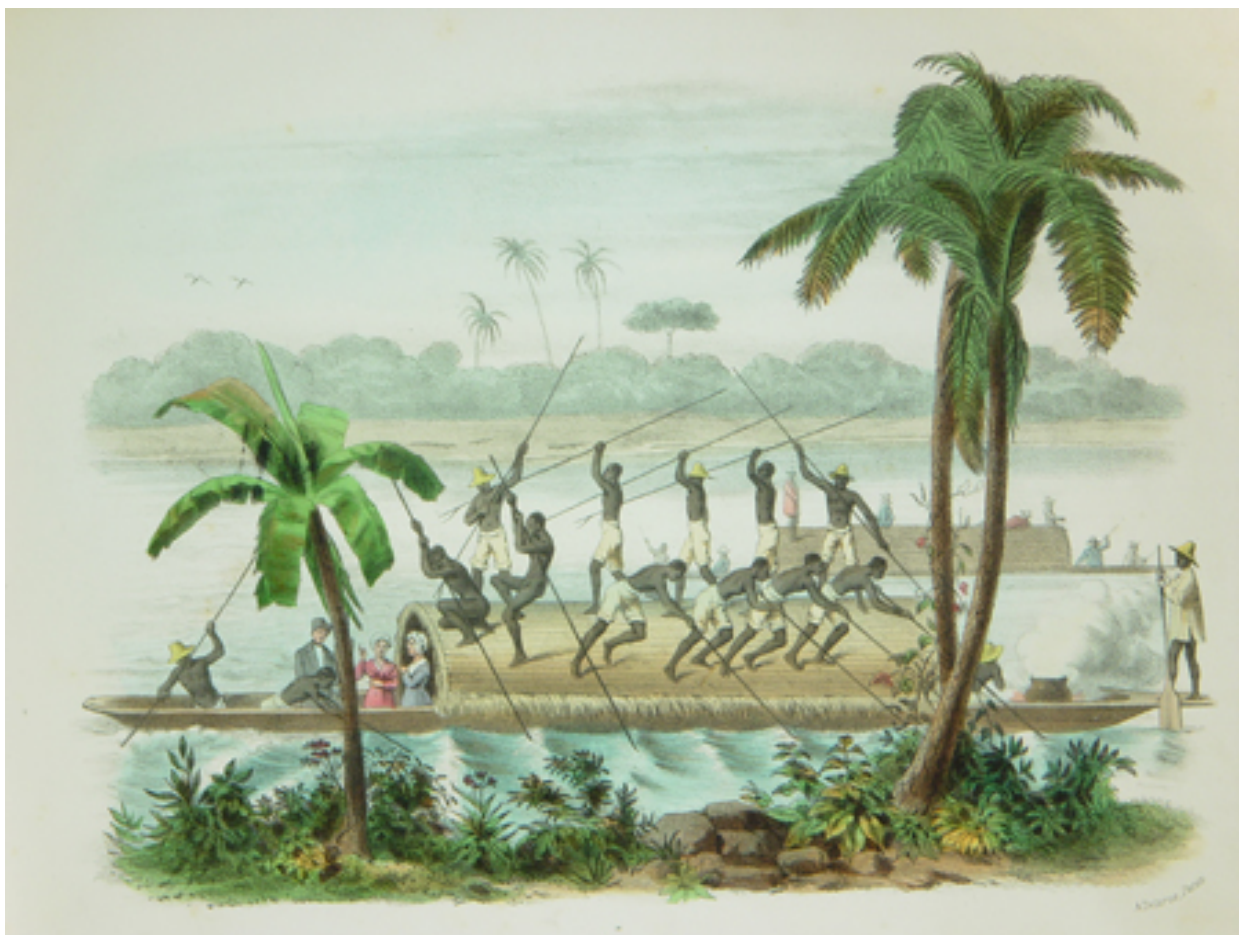
Fig. 3. Litografía que recoge el desplazamiento del champán mediante palanqueo, timonel sobre la plataforma horizontal de popa en un casco de concepción monóxila, la cobertura vegetal y el fuego a bordo. Fuente: “Champán en el río Magdalena” por Ramón Torres Méndez (Ca. 1860 – 1878).
