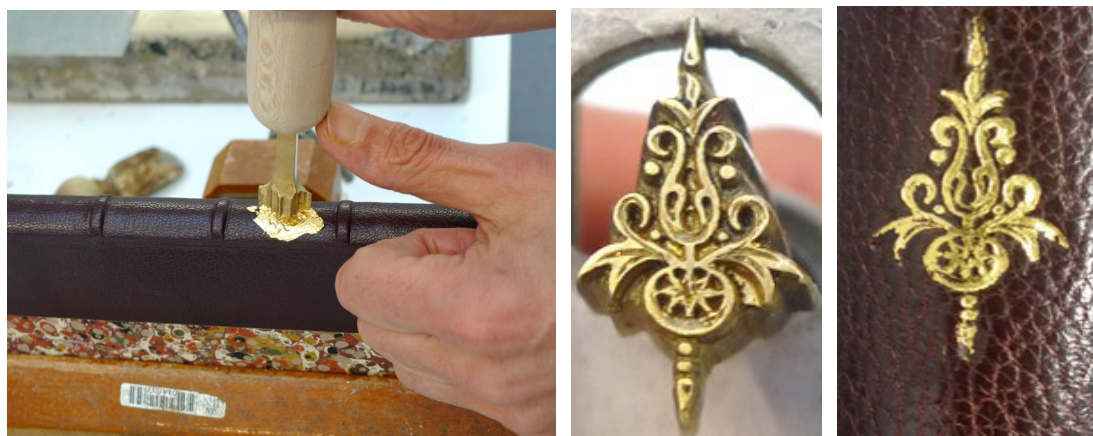
Fig. 24. Dorado del lomo mediante el empleo de un hierro (florón). Imágenes: Carlos Vera Carrasco.
