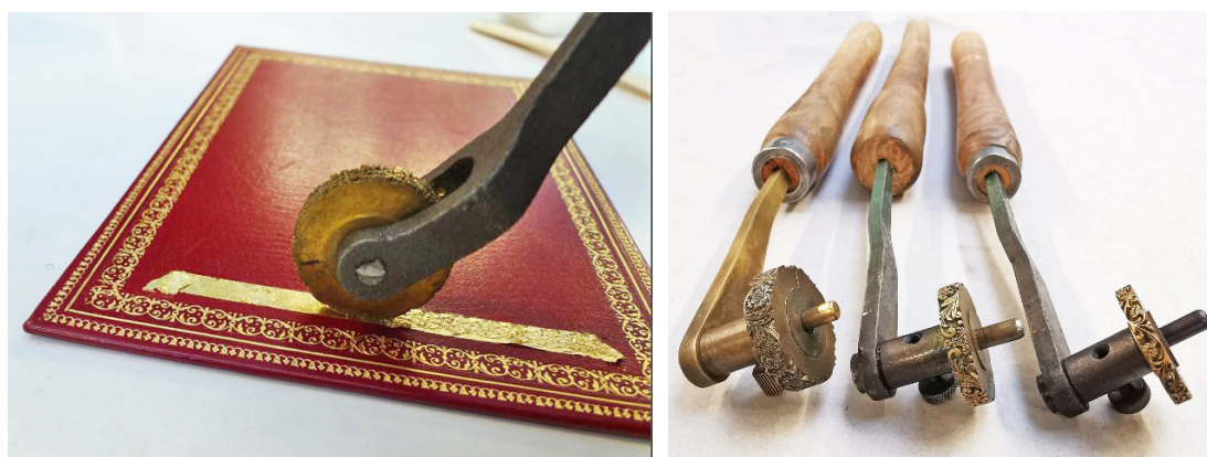
Fig. 25. Dorado del lomo mediante el empleo de la rueda. Imágenes: Carlos Vera Carrasco.
