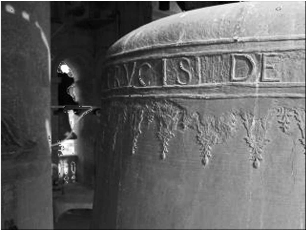
Figura 3. Vista de los hombros de la campana mayor o “Trinidad”, con parte de la antífona relativa al poder protector de la cruz. Repárese en los defectos de fundición que presenta.
