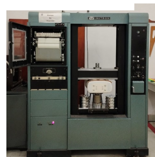
Figuras 9 y 10. Medición de la compresión en un simulador comercial.
