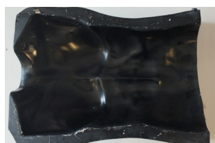
Figura 4. Molde para la fabricación de la piel sintética.
