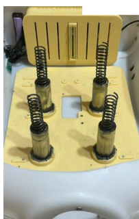
Figuras 7 y 8. Sistema mecánico de resistencia a la compresión (resortes).
