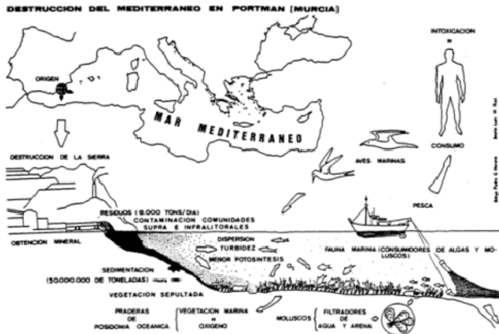
Fig. 36. Esquema del proceso de obtención del mineral y vertido al mar
