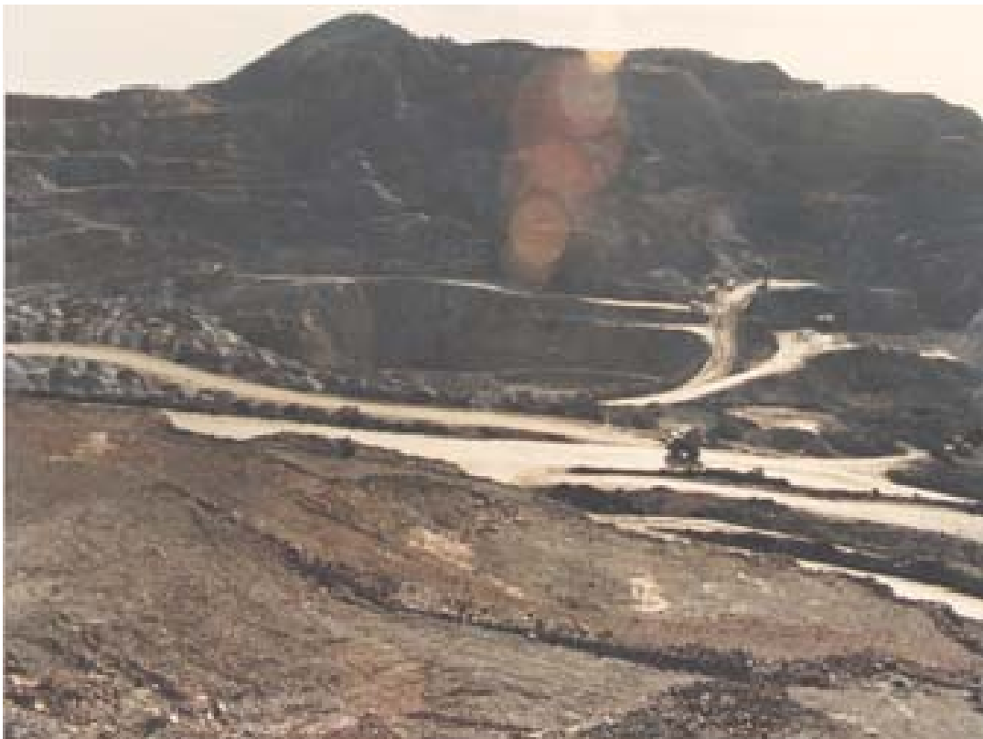
Fig. 58. Corta Tomasa en explotación, después acogió los vertidos del lavadero Roberto II
