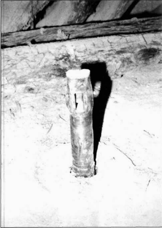
FOTOGRAFÍA 8. Primer plano del engranaje que, sujeto al quintal, servía para unirse al husillo.
