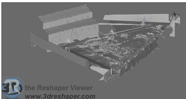
Lámina 6. Imagen del Paço dos bispos de Idanha-a-Velha obtenida con el Lasser escanner. Tratamiento de la información digitalizada con el programa Reshaper Viewer.
