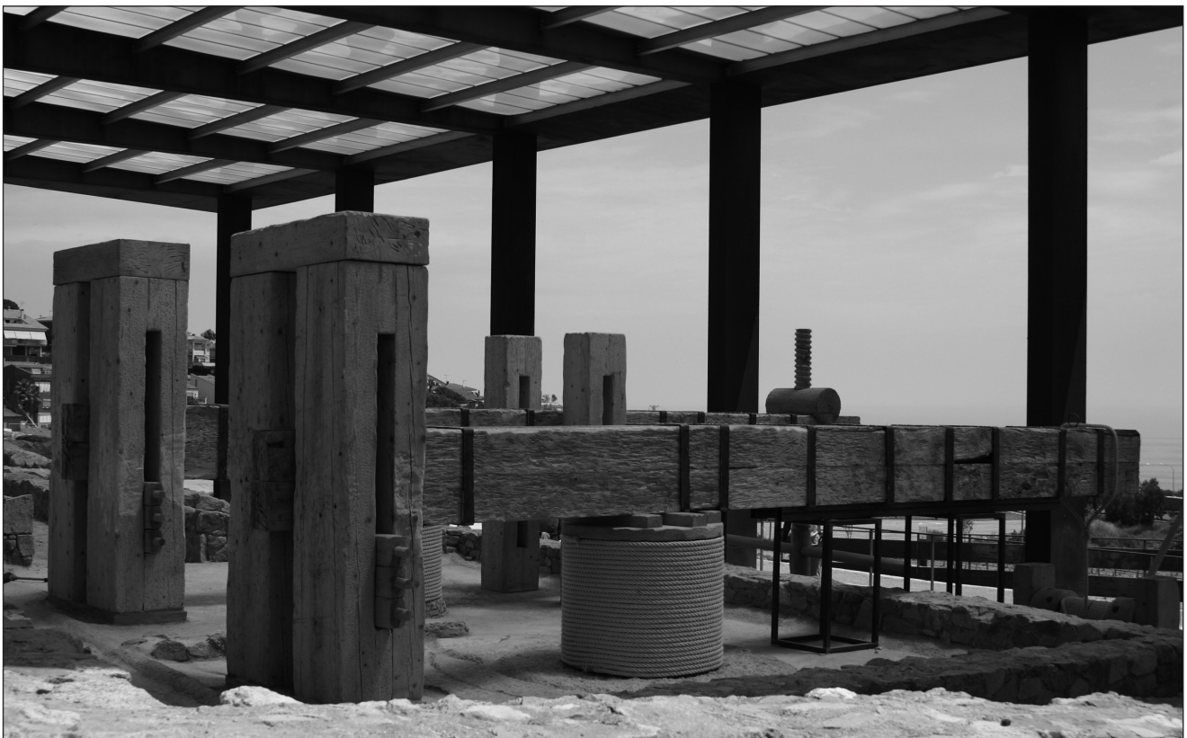
Figura 1. Restitución tridimensional del torcularium superior de Vallmora (ilust. Según Martín i Oliveras – Bayés 2008) y materialización del estudio anterior con la construcción de las dos réplicas de prensas romanas de viga in situ (según Sierra 2009).
