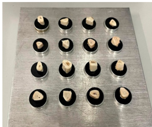
Figura 7. Muestras óseas tras la fijación, montadas en soportes de aluminio con cinta de carbono para evitar el movimiento y asegurar la conductividad, preparadas para su análisis mediante microscopía electrónica de barrido (SEM).
