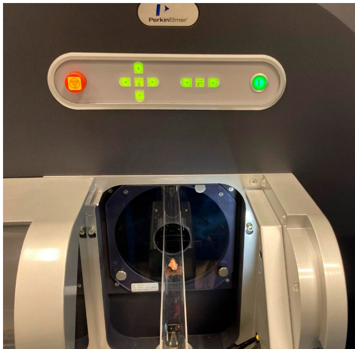
Figura 4. Detalle de la presentación de las muestras óseas (tibias) en el escáner Quantum GX2 microCT Imaging System (PerkinElmer, Shelton, CT, USA), disponible en el Servicio de Experimentación Animal de la Universidad de Murcia, previo a la adquisición de imágenes de microtomografía computarizada (micro-TC).
