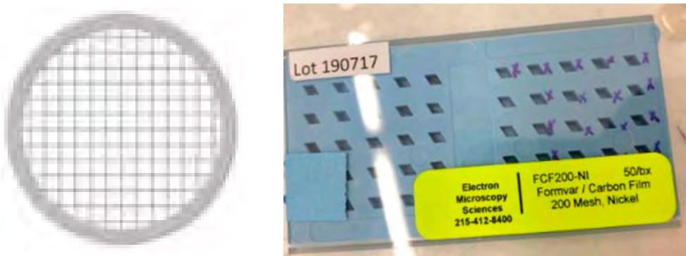
Figura 7. Imagen de una rejilla de níquel y caja de 50 rejillas de níquel con película de formvar para MET.
