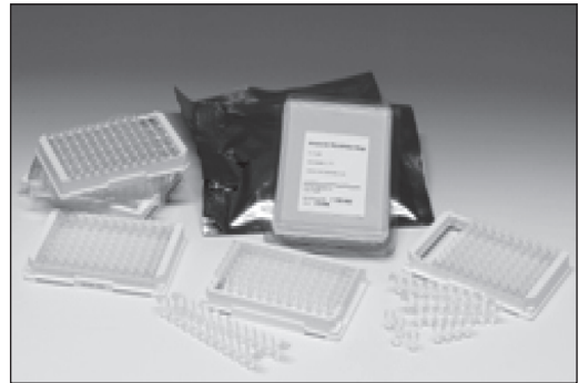
Figura 5: Placas de microtitulación empleadas rutinariamente en inmunoensayos basados en fluorometría en tiempo retardado.
