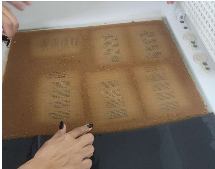
Figura 4. Reintegração de folhas do cordel na MOP. Fonte: Dados da pesquisa (2024).
